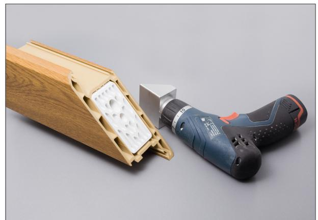
4. Flügel ist fertig zum Verschweißen.
