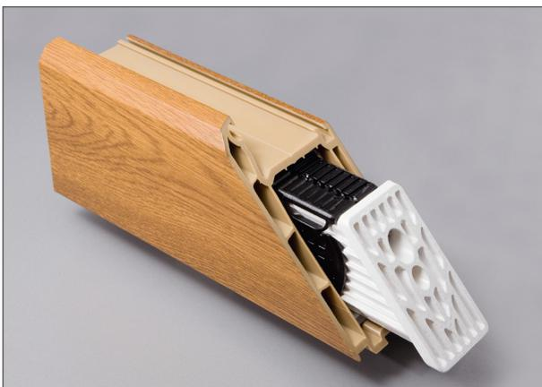
1. Eckschweißverbinder (141.530) in die Verstärkung des Profils einschieben und ausrichten (verschweißbare Fläche muss leicht zurück liegen).
